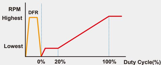
**PWM转速控制依据系统负载，自动保持静冷状态**
